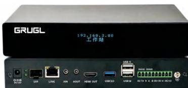
GDT-9006H-OUT: 分布式节点(4K60输出)
