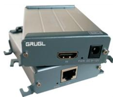
GFC-HD100-TR: 双绞线HDMI传输器(发射+接收)
